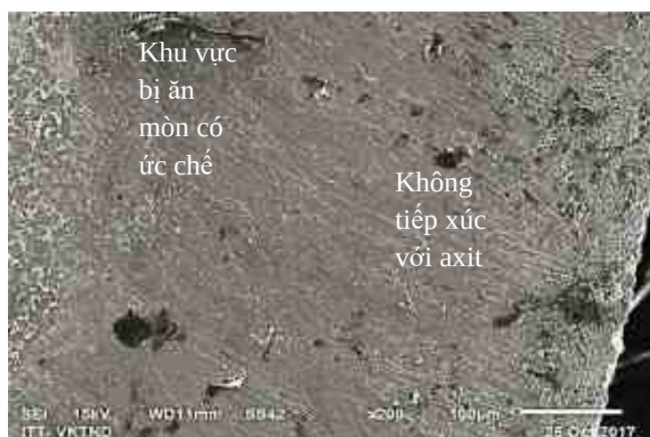
Hình 3.11. Bề mặt mẫu thép ở ranh giới ăn mòn
