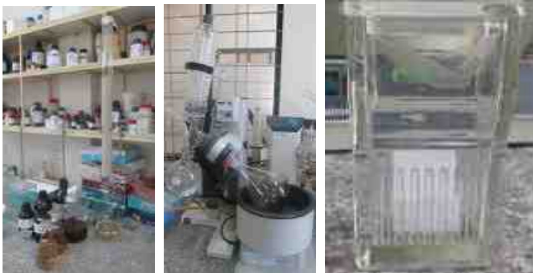
Hình 2.4. Kỹ thuật và thiết bị phân lập PDC: Sắc ký cột Dianion, cất quay chân không, sắc ký lớp mỏng
