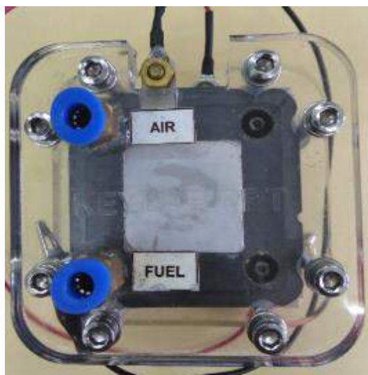
Hình 2.7. Mô hình DAFC, diện tích điện cực 10 \text{ cm}^2 ( 3,3 \times 3,3 \text{ cm} )
