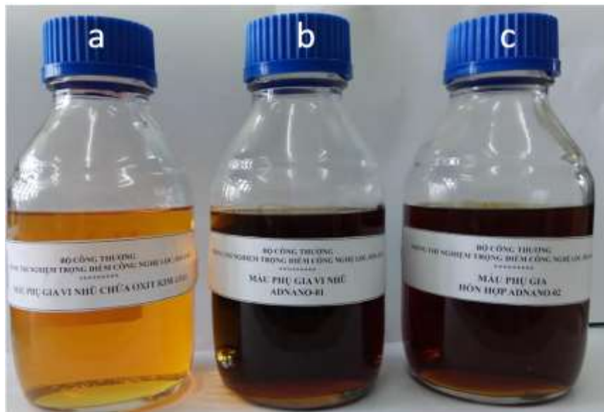
Hình 3.34. Hình ảnh các mẫu phụ gia hợp phần: Phụ gia vi nhũ chứa oxide sắt (a), phụ gia vi nhũ nước trong dầu (b) và phụ gia vi nhũ thế hệ mới (c)
