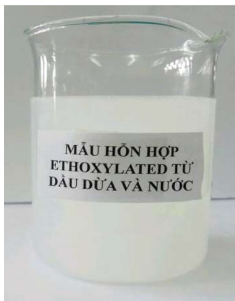
Hình 3.17. Sản phẩm diethanolamide dầu dừa ethoxyl hóa trong nước sau khi đã khuấy trộn mạnh
