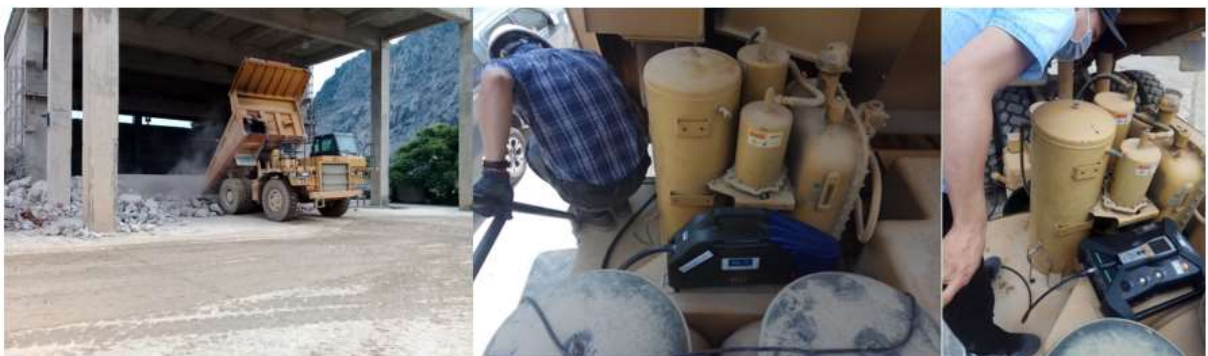
Hình 2.11. Thử nghiệm phụ gia vi nhũ thể hệ mới trên xe tải mở 36 tấn
