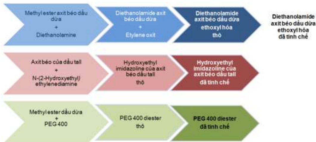
Hình 2.1. Các quy trình/công đoạn cần khảo sát trong nghiên cứu điều chế chất HDBM
