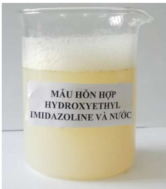
Hình 3.28. Hydroxyethyl imidazoline và nước, sau khi khuấy mạnh Bảng 3.26. Đặc trưng tính chất của hệ phụ gia vi nhũ pha chế từ chất HDBM hydroxyethyl imidazoline
